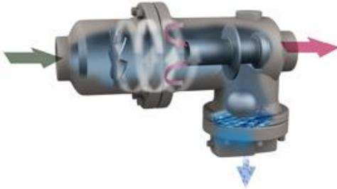
Сепараторы газа / жидкости Eaton Type 31 L-ST, ранее называвшиеся Wright Austin, автоматически удаляют 99% всех уносимых жидких и твердых частиц размером 10 микрон или более из процессов обработки воздуха, газа и пара. Этот компактный горизонтальный разделитель опирается на линию и занимает мало места.
