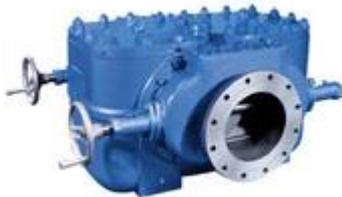
Дуплексные сетчатые фильтры удаляют повреждения, вызывающие появление твердых частиц в технологической среде, и их никогда не нужно останавливать для очистки... линия может работать непрерывно. Когда один комплект сетчатых корзин наполняется в сетчатом фильтре с несколькими корзинами модели 570, поток переключается на другой набор. Первый комплект корзины удаляется, очищается и снова готов к использованию.
