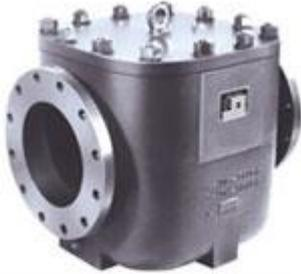
Симплексный сетчатый фильтр модели 510 отличается от других симплексных фильтров большого размера благодаря своей конструкции с несколькими корзинами. Четыре сетчатые корзины служат для деформации технологической среды и придают сетчатому фильтру чрезвычайно высокую способность удаления грязи. Сетчатый фильтр защищает такие компоненты системы, как расходомеры, насосы и форсунки.
